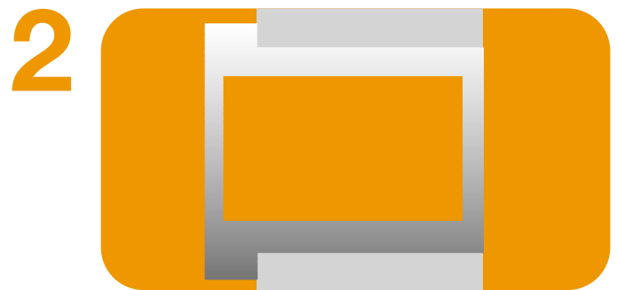
Montage du palier iglidur® dans l'alésage poinçonné Assembly of iglidur® bearing with transition fit
